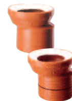
Acanalados: Para introducir dentro de tubo Ø110 Desplaza 12 mm
