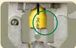
La presión de ajuste de las mordazas debe ser controlada con el tornillo de ajuste y tuerca de traba, para que el tubo esté perfectamente sujeto al expandir.
