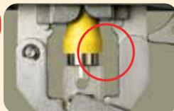
Tanto la presión inadecuada de las mordazas, como no colocar el tubo a tope (paso 1), acorta incorrectamente el tramo del tubo expandido.
