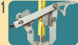
Levantar la palanca de las mordazas (A). Abrir las palancas de expansión (B). Introducir el tubo dentro del cabezal expensor **hasta hacer tope**.
