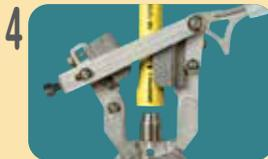
Abrir las palancas B y levantar la palanca A. Retirar el tubo expandido.
