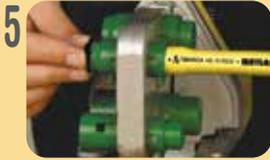
Con el termofusor conectado y la luz verde encendida (**en régimen**), introducir el **tubo correctamente expandido** en la boquilla macho y el **buje testigo** en la boquilla hembra, sosteniéndolos firmemente perpendiculares a la plancha del termofusor. Ambos se introducen hasta hacer tope.
