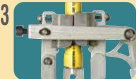
Expandir el tubo, cerrando las palancas B. Verificar que todo el cabezal esté dentro del tubo.
