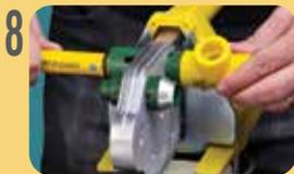
Con el termofusor en régimen, introducir el **conjunto tubo-buje** en la boquilla hembra. El **accesorio** se introduce hasta el tope de la boquilla macho. Al introducir el tubo, el aro testigo toma contacto con la boquilla y se separa del buje.
